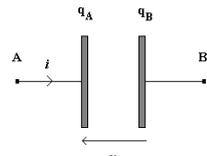
2. Orientation d'un circuit en utilisant la convention récepteur.
